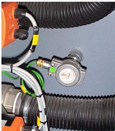
Le thermocouple de la chambre secondaire se trouve dans la chambre de combustion secondaire à l'arrière de la machine.
